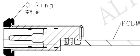
Assembly Way 組裝方式，左右方向裝配
