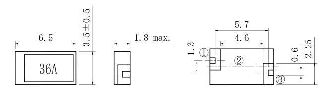
Tolerance:  $\pm 0.3$ Unit:mm
