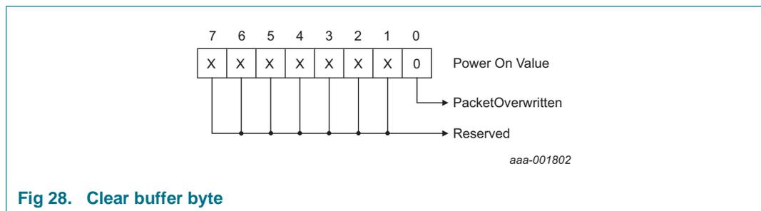
**Fig 28. Clear buffer byte**
