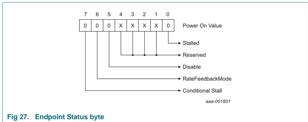
**Fig 27. Endpoint Status byte**
