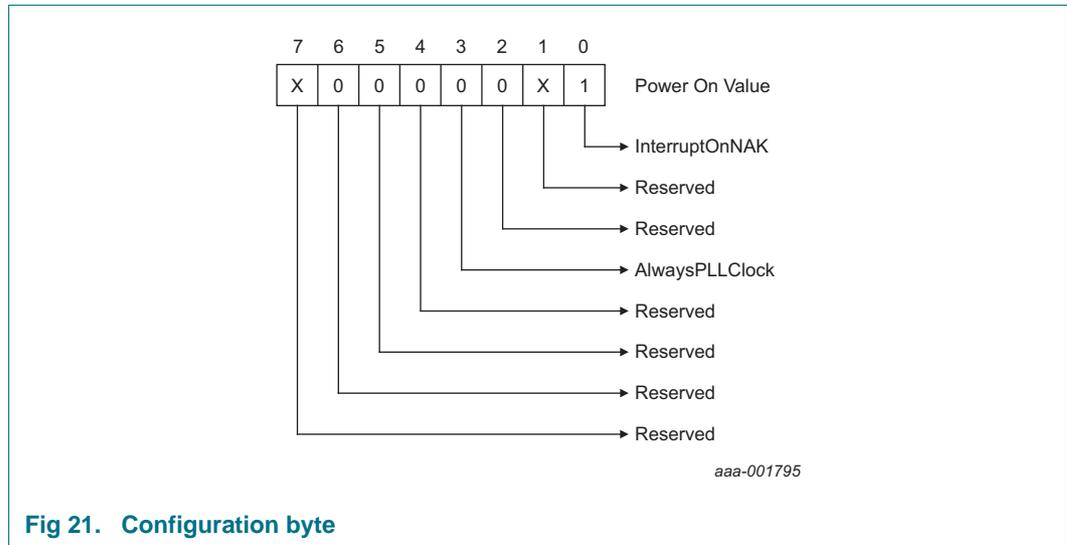
**Fig 21. Configuration byte**
