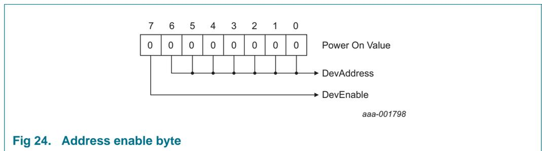
**Fig 24. Address enable byte**
