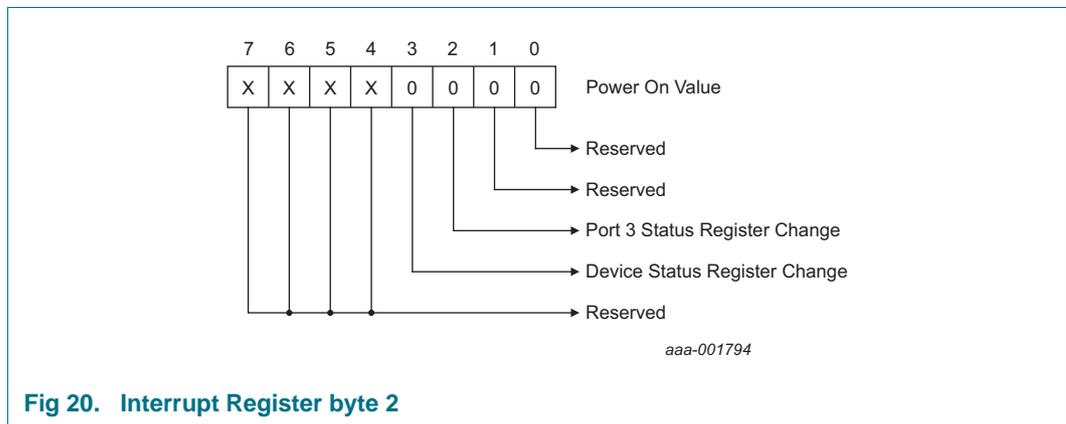
**Fig 20. Interrupt Register byte 2**
