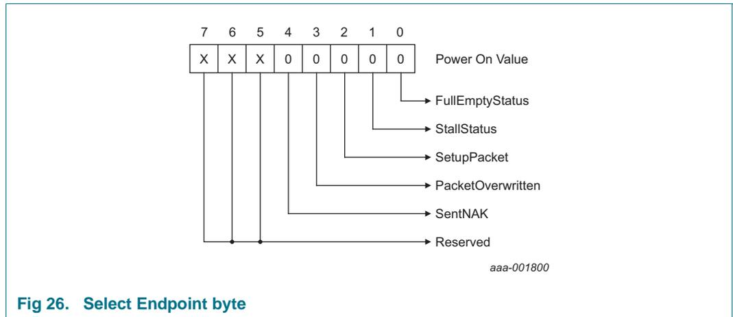
**Fig 26. Select Endpoint byte**
