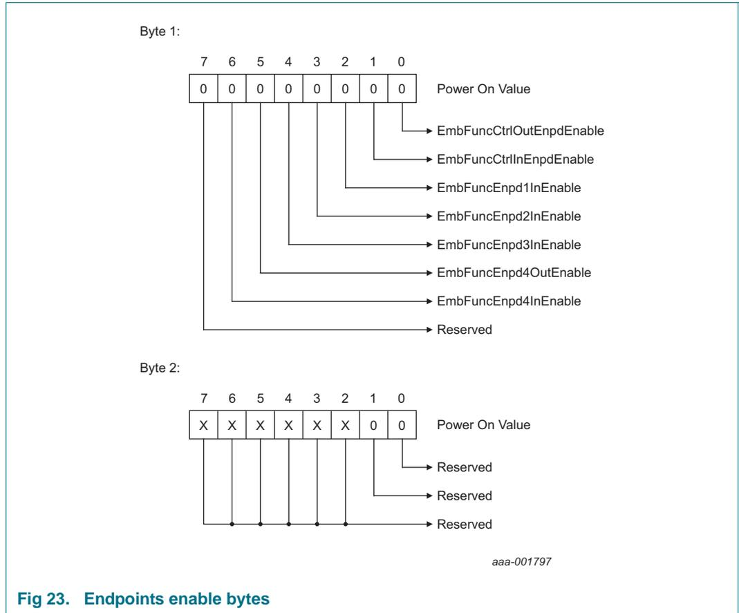
**Fig 23. Endpoints enable bytes**
