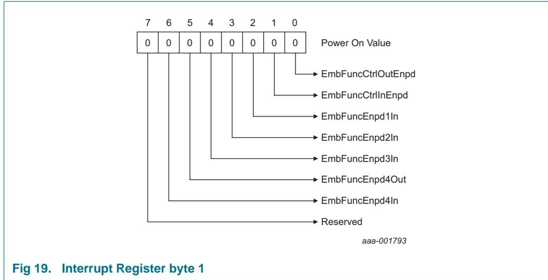
**Fig 19. Interrupt Register byte 1**
