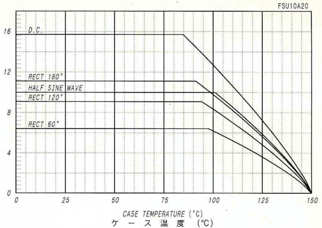
平均順電流－ケース温度定格 AVERAGE FORWARD CURRENT VS. CASE TEMPERATURE
