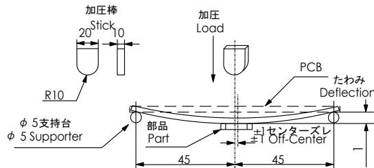
基板厚み / PCB thickness : 0.8mm
