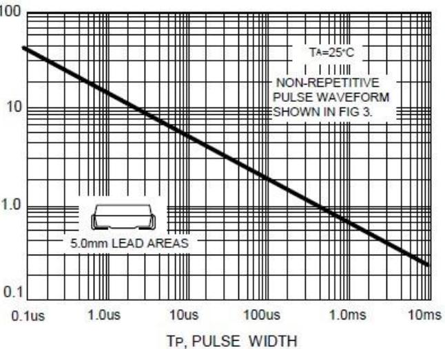
PM(AV) STEADY STATE POWER DISSIPATION (W)
