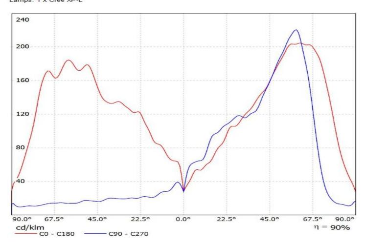
Luminaire: Ledil Oy CS15886\_STRADA-IP-2X6-T2-B-90\_(XP-L)\_SIMULATED Lamps: 1 x Cree XP-L
