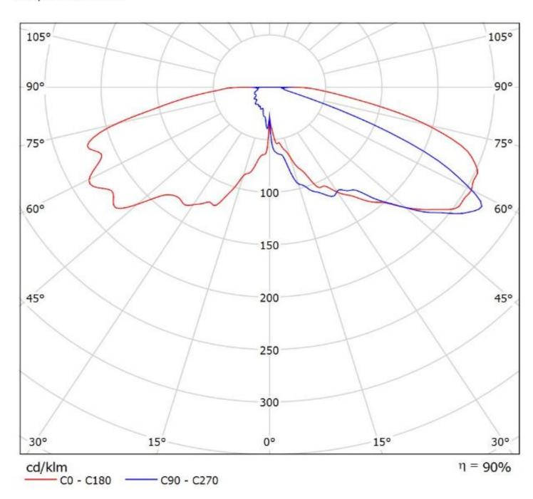
Luminaire: Ledil Oy CS15886\_STRADA-IP-2X6-T2-B-90\_(XP-L)\_SIMULATED Lamps: 1 x Cree XP-L
