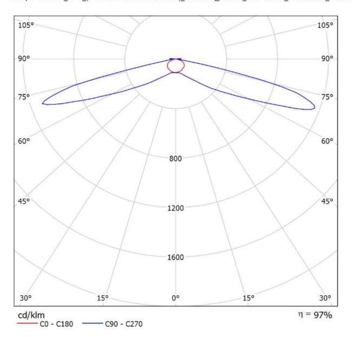
Luminaire: LEDiL Oy CS15158\_STRADA-IP-2X6-T4-B\_(XP-L)
