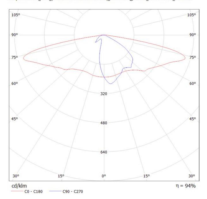
Luminaire: Ledil Oy CS15689\_STRADA-IP-2X6-FW\_(XP-L)\_SIMULATED
