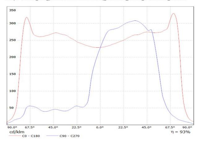
Luminaire: LEDiL Oy CS15363\_STRADA-IP-2X6-T2-B\_(XP-L)
