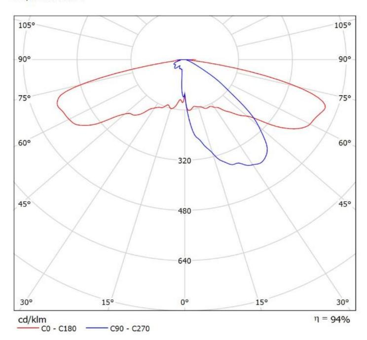
Luminaire: Ledil Oy CS15887\_STRADA-IP-2X6-T3-B-90\_(XP-L)\_SIMULATED Lamps: 1 x Cree XP-L
