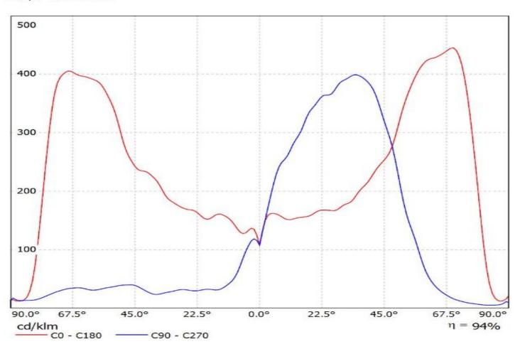
Luminaire: Ledil Oy CS15887\_STRADA-IP-2X6-T3-B-90\_(XP-L)\_SIMULATED Lamps: 1 x Cree XP-L
