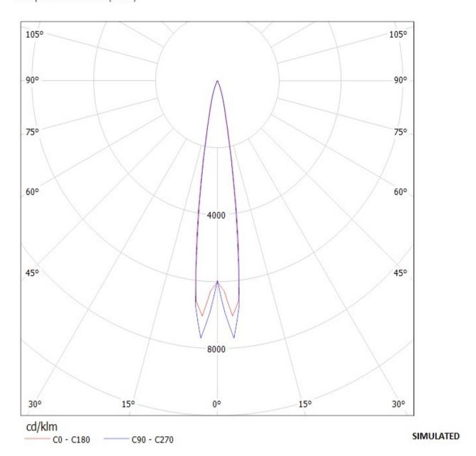
Luminaire: Ledil Oy FA10614\_LM1-M FA10614\_LM1-M Lamps: 1 x Cree MC-E (white)
