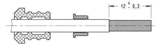
STEP 21 PUSH THE SHIELD BRAID BACK AND OVER THE CABLE JACKET CUT ROD FILLER STRIP THE TWO INNER WIRES TO LENGTH INDICATED
