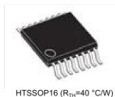
HTSSOP16 ( R_{\theta JA}=40^{\circ}\text{C/W} )
