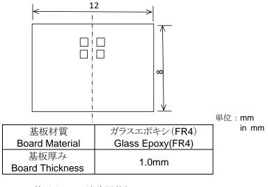
第6図 試験用基板 Figure6. Test Board
